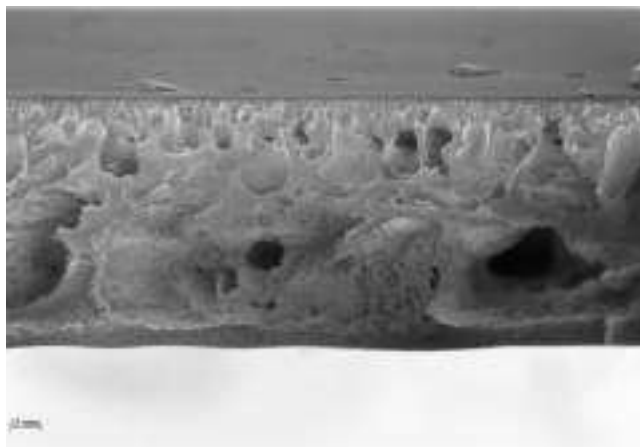
Рис.1. Снимок СЭМ поперечного скола мембраны, изготовленной из смеси АЦ и НЦ, взятых в соотношении 1:3
