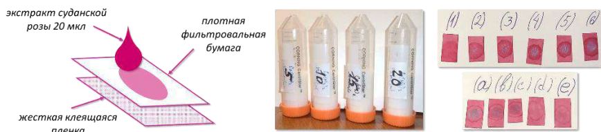
Рис. 1. Слева: схема изготовления тест-полосок. В центре: образцы разбавленного коровьего молока. Справа: тест-полоски с образцами разбавленного коровьего молока и других напитков.
