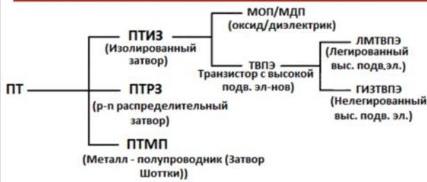
Рис. 1. Эволюция полевых транзисторов<sup>(1)</sup>
