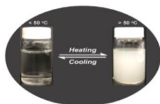
Температурная зависимость пропускания для водного раствора P(ACL-co-OEG2A) с различными соотношениями ACL и OEG2A
