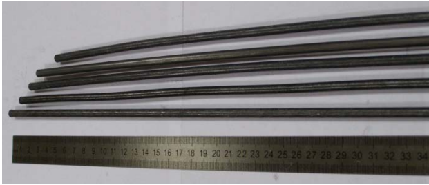
Рис. 2. Экспериментальные образцы наноструктурированных прутков титана Grade 4 диаметром 6 мм и длиной 1 м.
