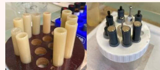
Изготовление ИСЭ: слева – мембрана фиксирована на клей, справа – нанесена поливом
