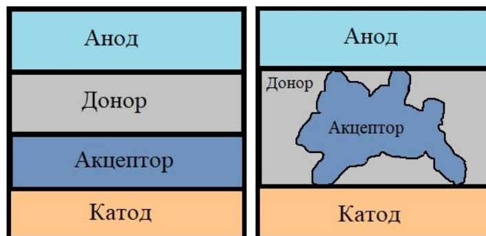
Рисунок 1. Схематичное изображение структуры ОСЭ. Первая структура - планарного типа, вторая – с объемным гетеропереходом.
